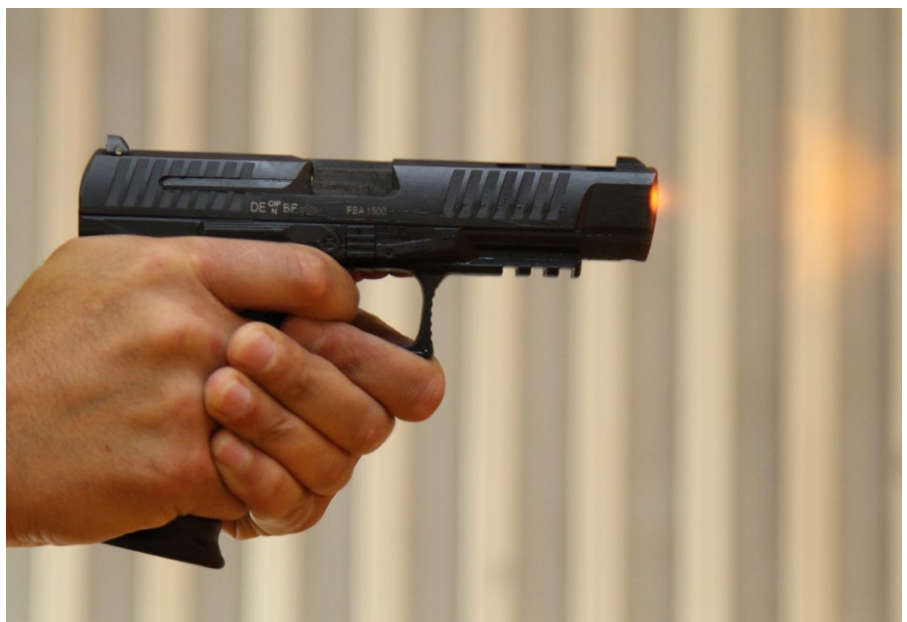
Testwaffe aus laufender Produktion: Walther PPQ M2 mit 5 er -Lauf und optionaler Stahlvisierung mit Superluminova Einsätzen
