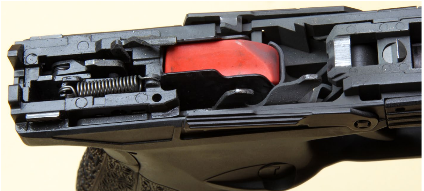
Verschmutzungsgrad nach Eintausend Schuss GECO Hexagon
